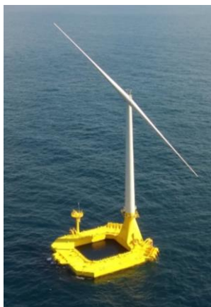
＜水深の浅い海域・港湾でも利用可能な低コスト浮体式洋上風力発電システム実証機＞
